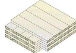
国内においては、スギの間伐材を利用して製造されており、平成25年12月にJASの制定、平成28年3月、4月にCLT関連の建築基準法告示の公布・施行により、一般利用が始まりました。
