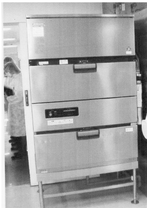
図-4 掃除用具を入り易くするため架台を設置。
